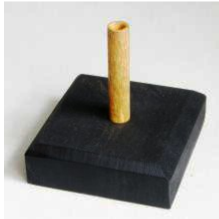
Stojak do skręcania patronów 0,36". Kołek ma średnicę 8,7 mm.
