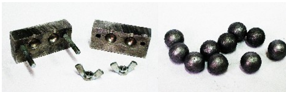
Kulolejka własna do kul 0,36; kule obtaczane i smarowane
